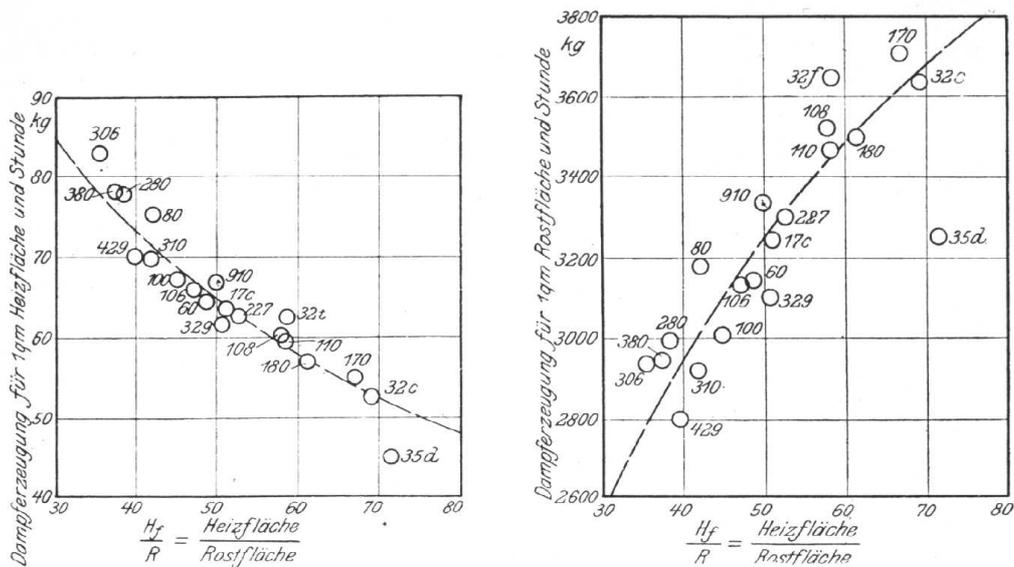
Neendampfleistung von Lokomotivkesseln nach Sanzin-Köchy für Stückkohle von 6250 kcal/kg ohne Speisewasservorwärmung, in Abhängigkeit vom Verhältnis der Verdampfungsheizfläche zur Rostfläche; im linken Bild bezogen auf die Heizflächeneinheit, im rechten auf die Rostflächeneinheit.
